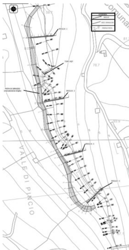
Figura 2 - Canale Pincio – Planimetria sistemazione individuazione briglie e piste di servizio.
