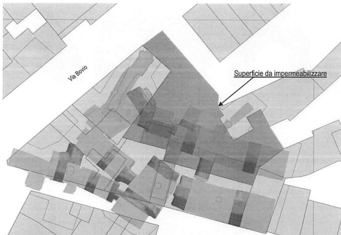
FIG. 4.4 - CAVITÀ 17 – SUPERFICIE OGGETTO DI IMPERMEABILIZZAZIONE
